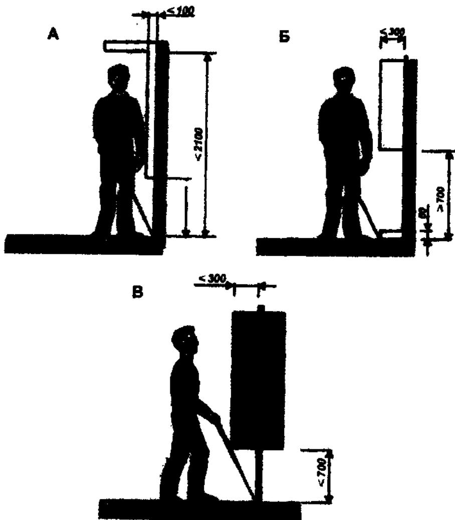
А - допустимые параметры вертикальных преград, размещенных параллельно стене;
